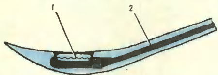
Схема бесшпурового ЭГ-разрушения валунов: 1 — проволоочный взрывающийся тепловой элемент, 2 — встроенный токопровод
